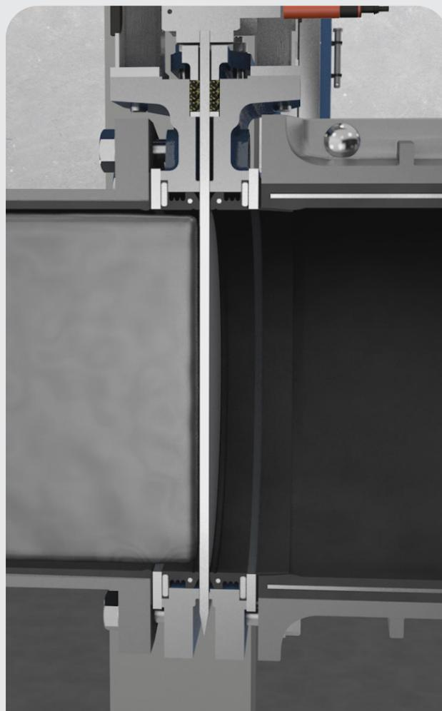
Cuando la válvula pasa a la posición cerrada, los dos asientos se desplazan axialmente para formar un sello con la compuerta hasta llegar a un cierre completo, 100 % hermético en cualquier dirección de la presión.
